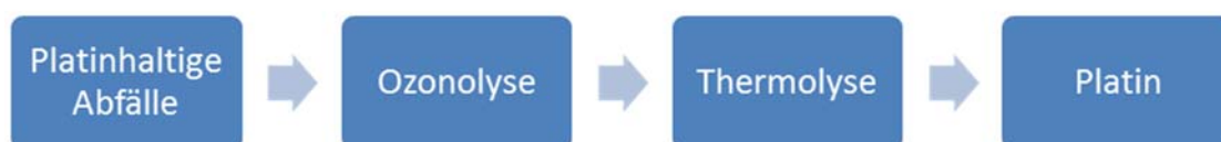
Abbildung: Schematische Darstellung des angestrebten Recyclingprozesses.
