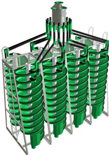
Bild 1: Ansicht einer Sortierspiralen-Bank
