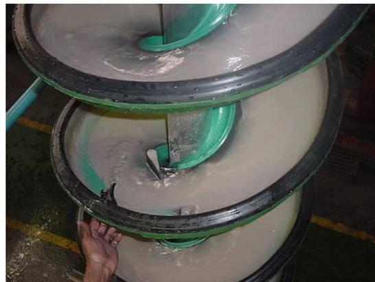
Bild 2: Die neue Cleaner Spirale im Betrieb
