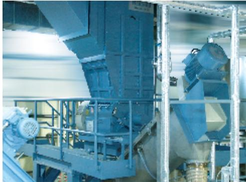
Nassschneidmühle Typ SML 60/145 SX5-2, 110 kW mit
