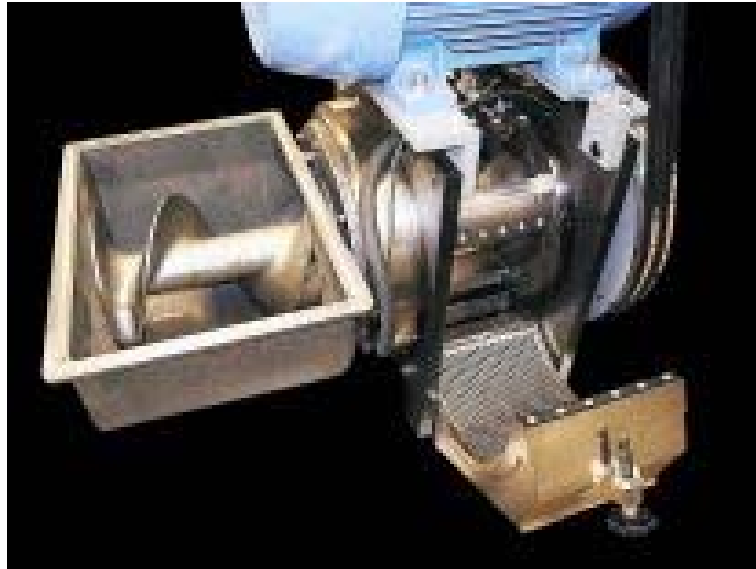
Bild 2: Dosierschnecke mit offenem Siebkorb und Rotor
