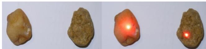
**Abbildung 1: TOMRA multikanal Laser Detektion zur Unterscheidung von Quarzpartikel von Kontamination mit identischer Farbe (Chadwick, May 2017)**
