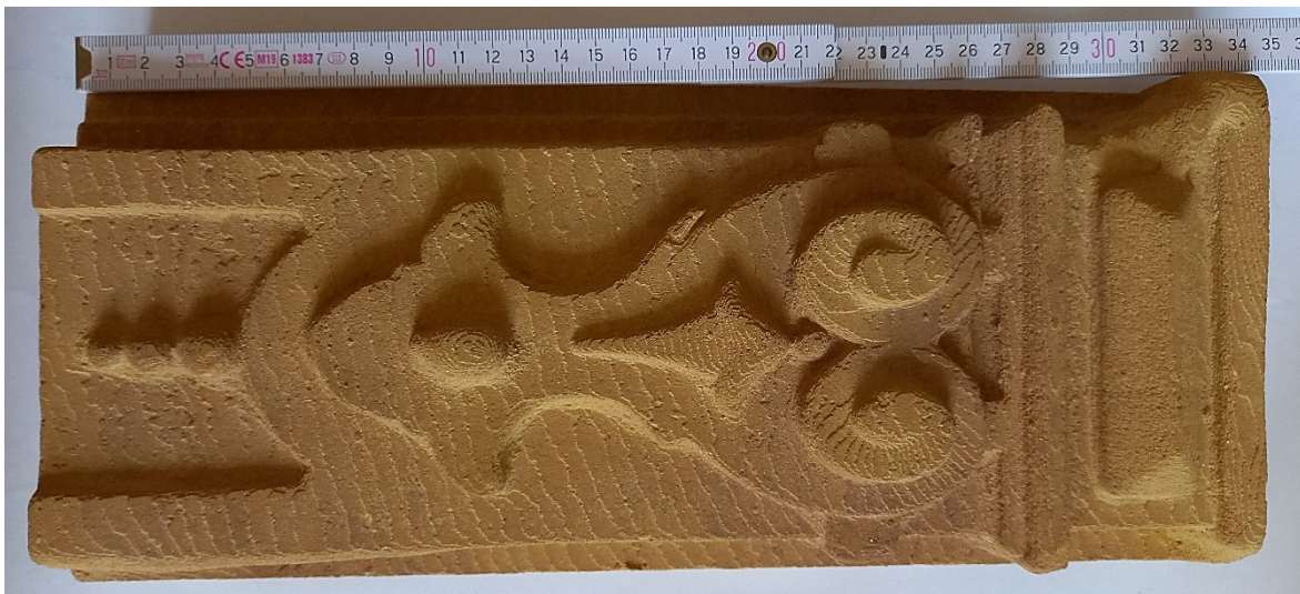
Abbildung: gescannter Stuck mittels Binder Jetting aus Steinrestauriermörtel gefertigt
