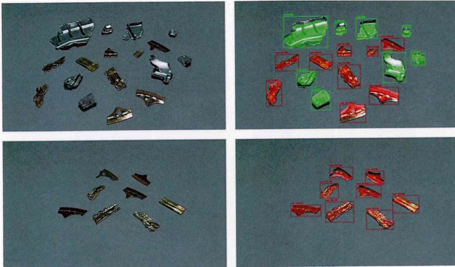
Abbildung 1: Dynamische Bildererkennung von Aluminiumpartikeln sowie Fremdstoffen mittels KI
